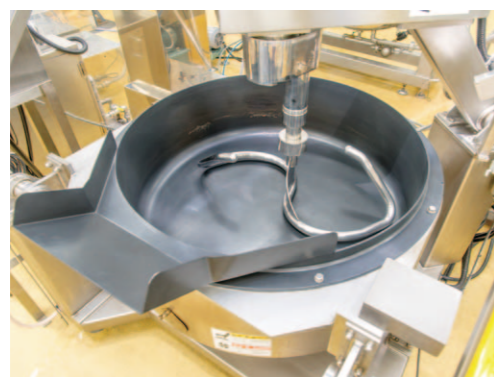
麺などの材料を傷つけずに調理する品川工業所オリジナルのS型羽根。
