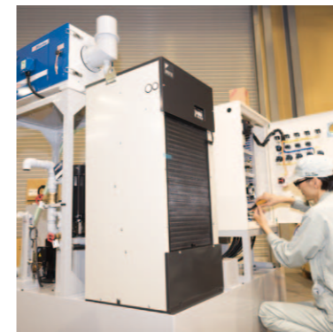
機械などを冷却するためのクーラント装置。一つとして同じシステムのない同社製品は、全て技術者たちの手づくり。
